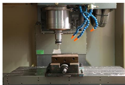
本系 CNC 銑床精密加工情形
