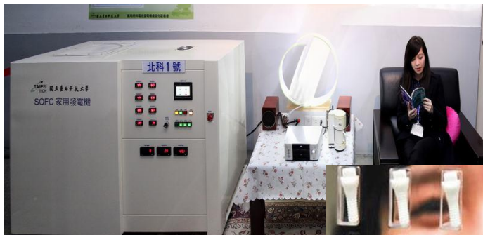
↑ 北科 1 號家用型固態氧化 化物燃料電池組 (SOFC)
