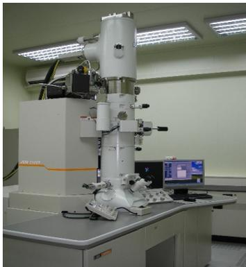
場發射穿透式電子顯微鏡
