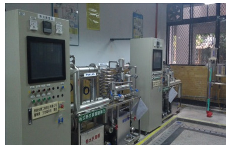
熱交換實驗裝置
