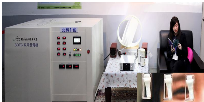
↑ 北科1號家用型固態氧化物燃料電池組 (SOFC)
